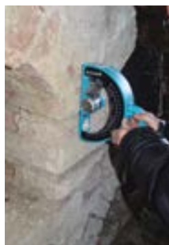
Badania niszczące struktury murów: a) pomiar wilgotności w głębi muru; b) pomiar liczby odbicia młotkiem wahadłowym; c) pomiar liczby odbicia młotkiem typu L
