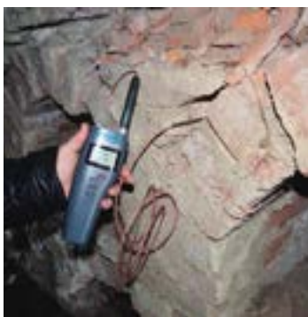
Badania niszczące struktury murów: a) pomiar wilgotności w głębi muru; b) pomiar liczby odbicia młotkiem wahadłowym; c) pomiar liczby odbicia młotkiem typu L
