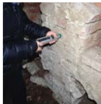
Badania niszczące struktury murów: a) pomiar wilgotności w głębi muru; b) pomiar liczby odbicia młotkiem wahadłowym; c) pomiar liczby odbicia młotkiem typu L
