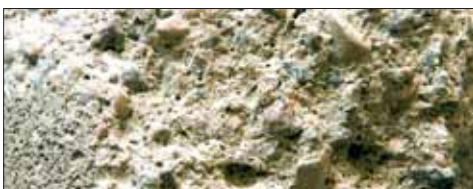
Rys. 6. Powierzchnia skarbonizowanej warstwy otuliny betonowej
