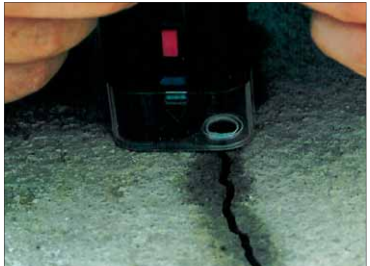
a) sposób pomiarów szerokości rozwarcia rys,
