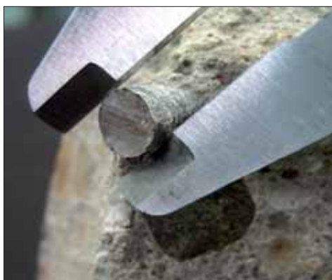
Rys. 3. Elementy uzyskane metodą odwiertów rdzeniowych badane według technologii [7]
