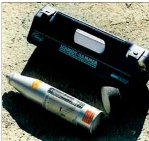
Rys. 4. Młotki Schmidta typu N: a) standardowy,
