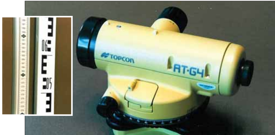
Rys. 9. Niwelator samopoziomujący z precyzyjną skalą odczytu, wykorzystywany do pomiaru odkształceń
