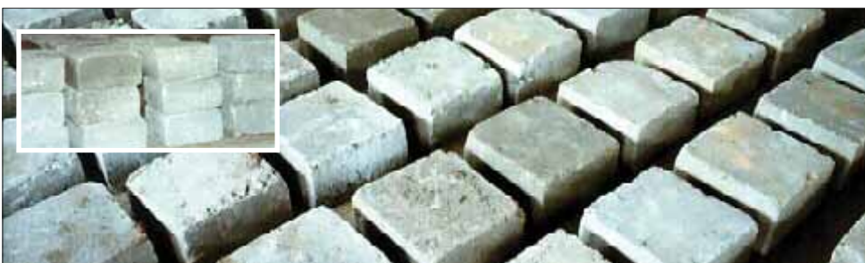
Rys. 12. Ortogonalny układ elementów obciążenia próbnego
