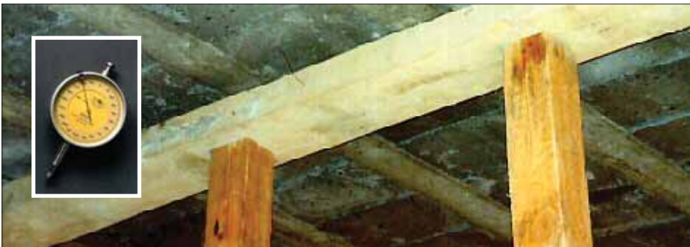
Rys. 10. Precyzyjne pomiary wartości ugięć rejestrowano czujnikami zegarowymi
