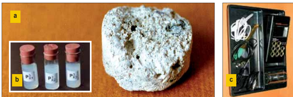
Rys. 9. a) struktura próbki betonu warstwy fakturowej, b) zawiesziny wodne przygotowane do badań stopnia pH, c) zestaw mikroprocesorowy do badań stopnia pH
