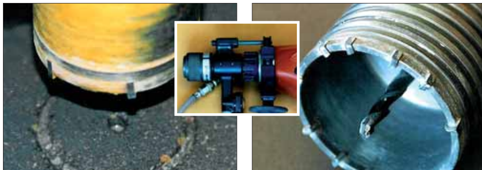
Rys. 8. Elementy zestawu wykorzystywane do wykonywania otworów w płytach fakturowych
