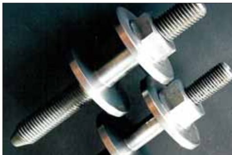
Rys. 7. Kotwie typu „L” i „C”, zrealizowane do badań w skali naturalnej
