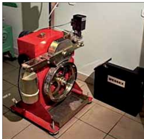
Stanowisko do badania odporności na polerowanie kruszyw drogowych: a) aparat do przyspieszonego polerowania, b) wahadło angielskie.
