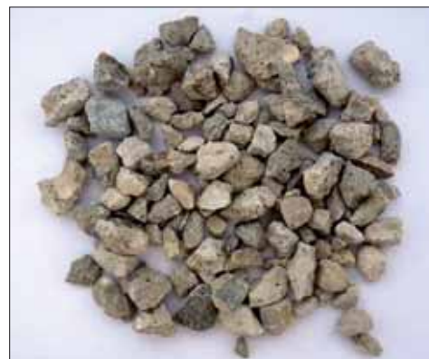
Fot.2 Kruszywo recyklingowe o uziarnieniu 4/16 mm
