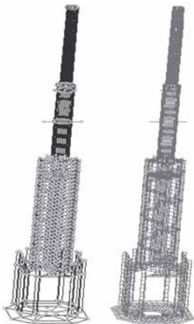
Rysunek 1 Model komputerowy wieży: dyskretyzacja szkieletu konstrukcji
