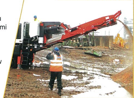
Mobilna kruszarka udarowa SANDVICK Q1240
