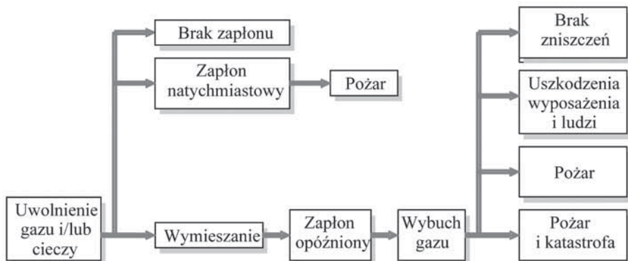
Rys. 2. Drzewo zależności obrazujące typowe konsekwencje zapłonu gazu lub lotnych par cieczy
