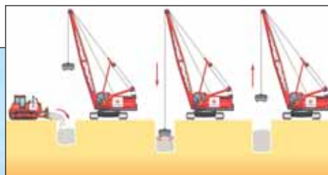
Schemat wykonania kolumn wymiany dynamicznej DR.
