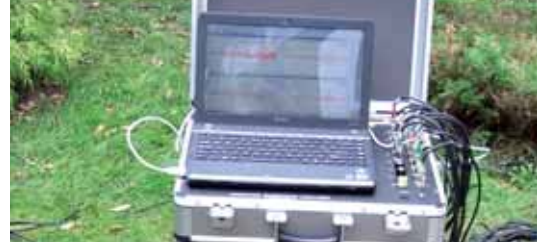
Rys. 3. Układ pomiarowy typu KSD-400 firmy Sensor.
