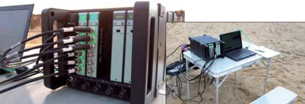
Rys. 2. Stanowisko pomiarowe bazujące na układzie pomiarowym typu LAN-XI firmy Brüel&Kjær.
