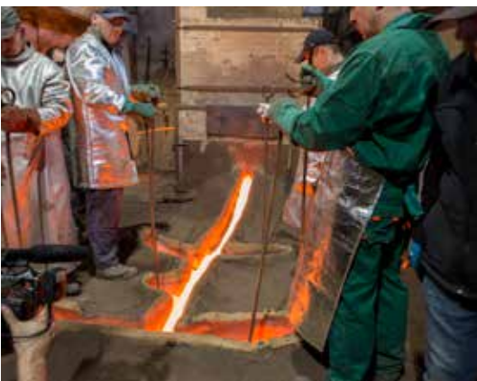
Wypuszczony z pieca materiał, najwyższej jakości stop miedzi i cyny, płynie wydrążoną w ziemi rynną i wlewa się do wnętrza formy
