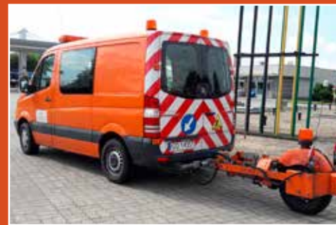
Skid Resistance Tester służący do badań odbiorowych warstwy ścieralnej pod względem współczynnika tarcia
