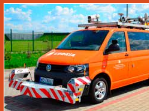
RSP (belka z przodu pojazdu) wraz z systemem LCMS (z tyłu pojazdu)
