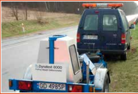
Falling Weight Deflectometer mierzący ugięcia sprężyste nawierzchni
