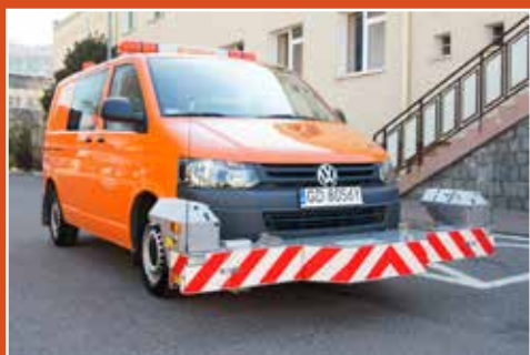
Profilograf laserowy RSP Road Surface Profilometer służy do mierzenia m.in. głębokości kolein, czyli trwałych odkształceń wzdłuż śladów kół
