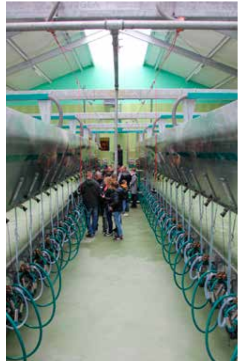
Wnętrze hali udojowej „bok w bok” na 40 stanowisk w oborze z 350 krowami Katarzyny i Rafała Bieniak z miejscowości Kózki koło Węgrowa
