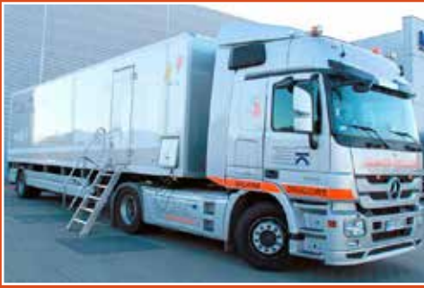
Traffic Speed Deflectometer – mobilny ugięciomierz laserowy, eliminujący ryzyko kolizji drogowych
