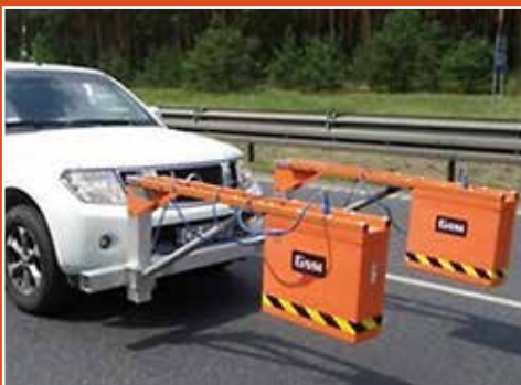
Georadar wykorzystuje fale elektromagnetyczne do badania konstrukcji drogi i podłoża gruntowego
