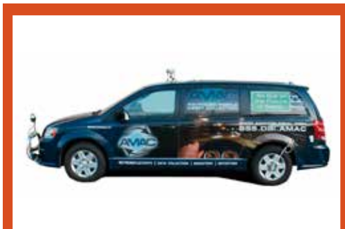
Advanced Mobile Asset Collection – urządzenie mobilne do pomiaru stanu oznakowania pionowego
