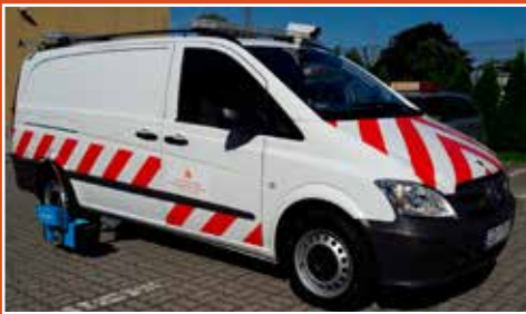
Road Marking Tester – urządzenie do pomiaru jakości oznakowania poziomego
