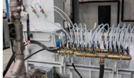
Miksery mieszające wióry ze spoiwem. Precyzja procesu ma decydujący wpływ na jakość otrzymanej płyty
