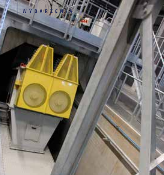
Odbiór zrębków pod rębakiem przenośnikami ślimakowymi
