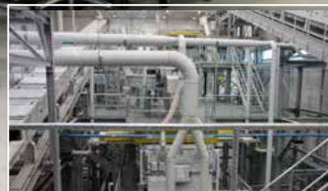
Początek linii formowania koberca ze zmieszanych ze spoiwem wiórów. Widoczne transportery wiórów drobnych i grubych oraz systemy odpylania
