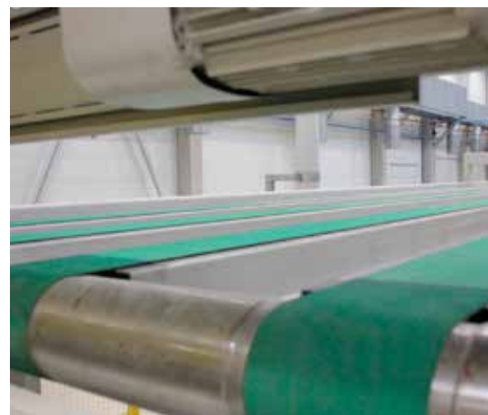
Taśma transportu gotowej płyty do zautomatyzowanego urządzenia sztablującego
