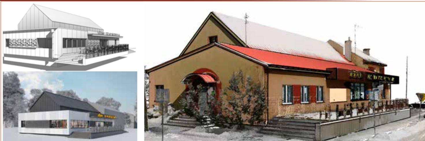
Rys. 4. Od chmury punktów – inwentaryzacja – koncepcje – wizualizacje – po projekt dokumentacji technicznej. Droga wymaga sprawnego poruszania się (wymiany danych) po paru oprogramowaniach. W tym przypadku Revit (Dynamo) – 3D Max-Vray – Adobe PS. Istotne jest odpowiednie przygotowanie modelu w Revit i kategorii elementów tak, aby eksport przebiegał bezproblemowo
