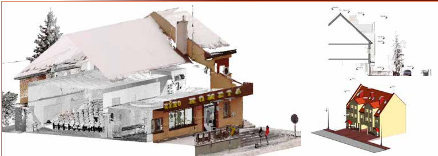
Rys. 2. Obróbka chmury punktów musi odbywać się małymi elementami. Powinno się ustawić dużo widoków i przekrojów z odpowiednio zawężoną widocznością. Unikniemy nawarstwienia punktów. Skan firma Limbus Białystok
