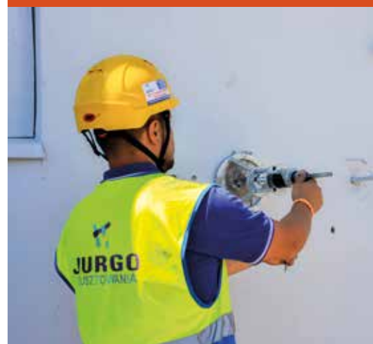
4. Pokaz wytrzymałości kotew chemicznych na wrywanie przyrządem firmy PIONART
