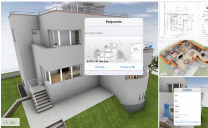
BIMx Hyper Model – przeglądanie modelu i dokumentacji BIM. Opracowanie własne na podstawie materiałów marketingowych firmy Graphisoft – model rekonstrukcji willi Balassa.
