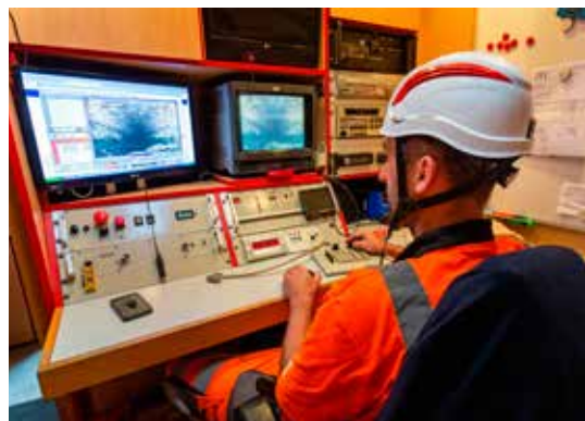
Renowację rękawem Aarsleff projektuje się indywidualnie dla każdego kanału na podstawie analizy kamerą TV
