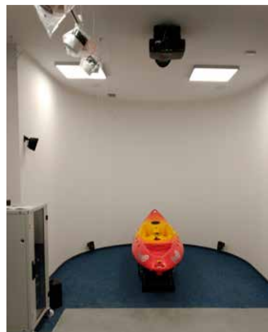
Symulator kajaka. Dla zapewnienia realizmu symulacji zastosowano zestaw nagłośnienia przestrzennego 5.1, wyposażony w cztery głośniki satelitarne, głośnik centralny oraz w subwoofer o mocy 165 W
