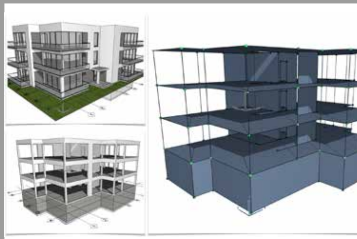
Model fizyczny, rdzeń elementów nośnych i elementy modelu analitycznego
