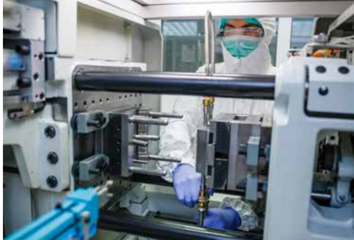
Produkcja implantów biowchłaniających (polimerowych) w technologii formowania wtryskowego w pomieszczeniu o kontrolowanej czystości
