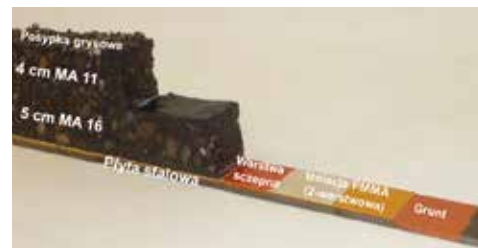
Przekrój nowoczesnej systemowej nawierzchni mostowej z dwuwarstwowym układem konstrukcji z asfaltu lanego wraz z izolacją natryskową z PMMA na płycie stalowej
