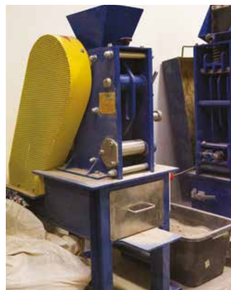
Kruszarka szczękowa – urządzenie do rozdrabniania gruzu betonowego
