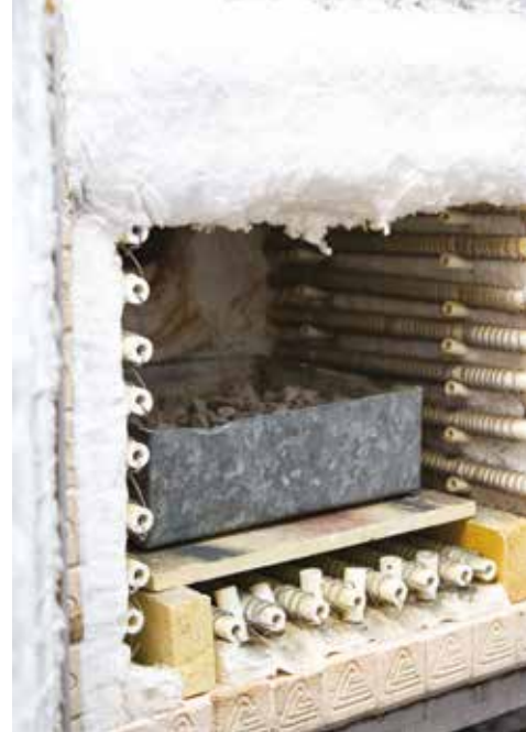
Piec ceramiczny wykorzystywany do prażenia, rozdrobnionego w kruszarce, gruzu
