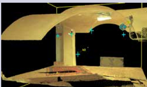
Oczyszczona z szumów chmura punktów z nałożonymi zdjęciami
