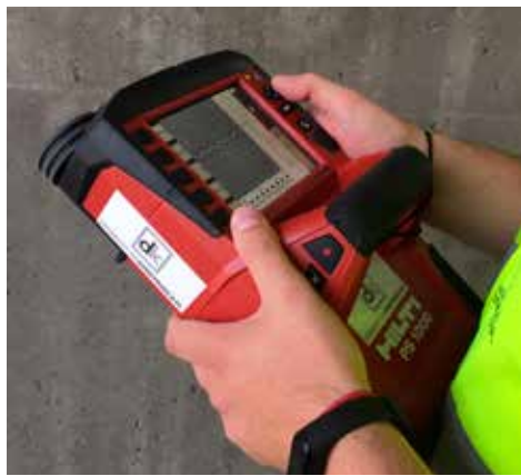
Przykład georadaru typu all-in-one o wysokiej częstotliwości środkowej, Hilti X-Scan PS1000, dedykowanego do badań betonu
